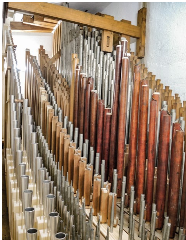
Pfeifen des Schwellwerks mit der rund gebohrten Traversflöte von Schulze, 1843.
