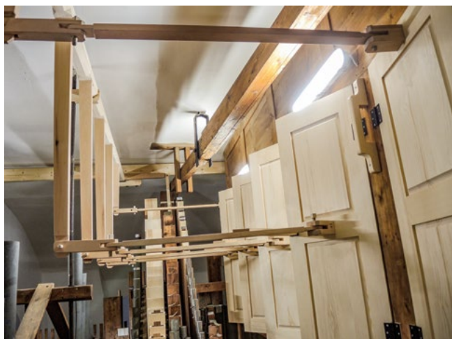
Schwellschranktüren mit Mechanik.
