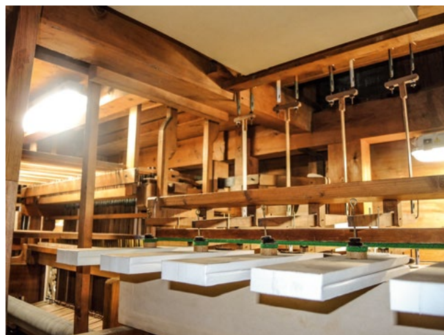
Barkermaschine unter der Windlade des I. Manuals.
