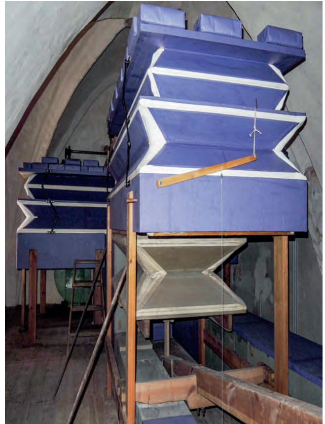
Die Balganlage. Vorn der Nebenbalg, dahinter der Hauptbalg.
