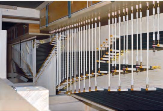
Wellenbrett mit Traktur unter dem Hauptwerk
