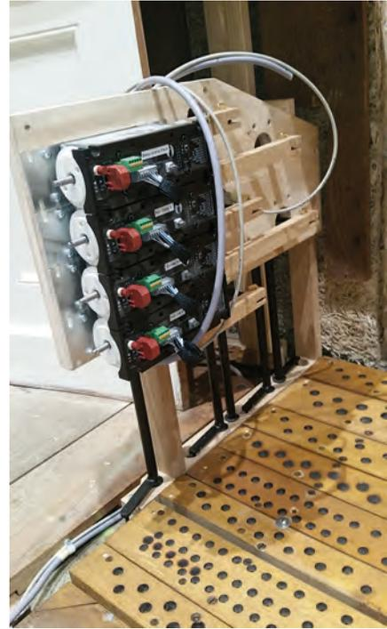
Registerschleifen am Rückpositiv mit Zugmagneten und Verbindungsgestänge
