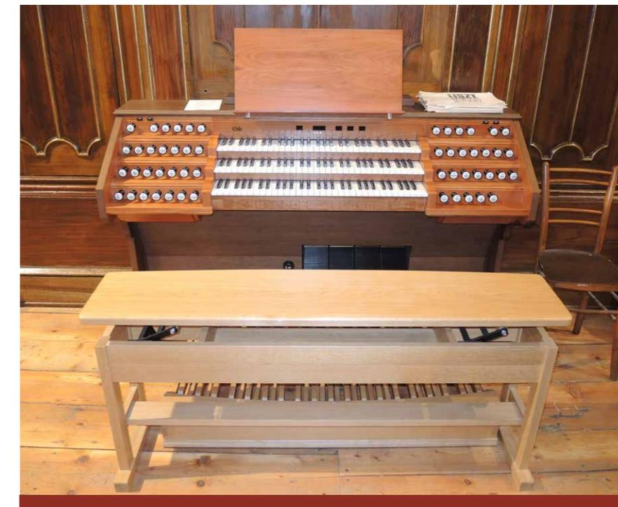
ist angebaut mit zweiarmigen Tasten. Die Koppeln arbeiten elektrisch. Mit MIDI-Anschlüssen in allen Klaviaturen lassen sich moderne Instrumente anbinden. Die Registertraktur ist elektrisch mit Setzeranlage System Eule, die einen offenen Bereich mit 10.000 Kombinationen vereint mit einem zusätzlichen Nutzerbereich mit Titelablage und unbegrenzter Kombinationszahl. Die Gebläseanlage mit großem Magazinbalg ist im Gehäuse integriert.
